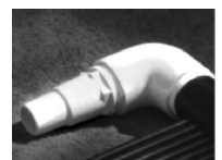
Abb. 5 Schrauben Sie nun die Kniestücke ebenso mit Teflonband zur Abdichtung auf die Gewinde des Sammelrohres mit Markierung . Überdrehen Sie die Kniestücke nicht.
